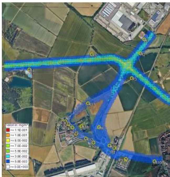
Figura 09.09 - Mappa delle isolinee della concentrazione mediata sulle 8 ore di CO attesa in atmosfera a causa della sorgente traffico nello SDP
