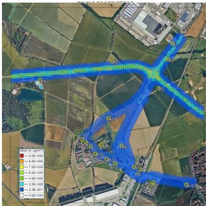
Figura 09.03 – Mappa delle isolinee del 90,4 esimo percentile della concentrazione media giornaliera di PM10 attesa in atmosfera a causa della sorgente traffico nello SDP
