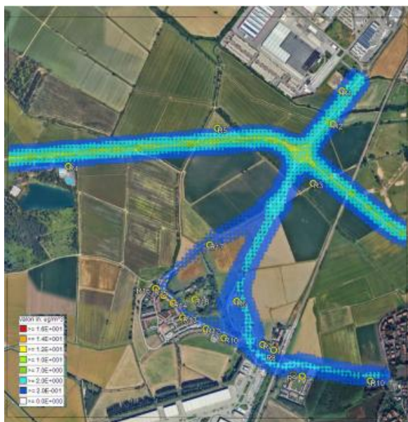
Figura 09.06 - Mappa delle isolinee della concentrazione media annua di NO2 attesa in atmosfera a causa della sorgente traffico nello SDP
