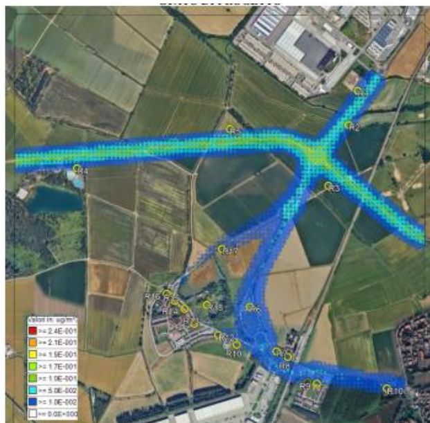
Figura 09.08 - Mappa delle isolinee della concentrazione media annuale della concentrazione media oraria di benzene attesa in atmosfera a causa della sorgente traffico nello SDP
