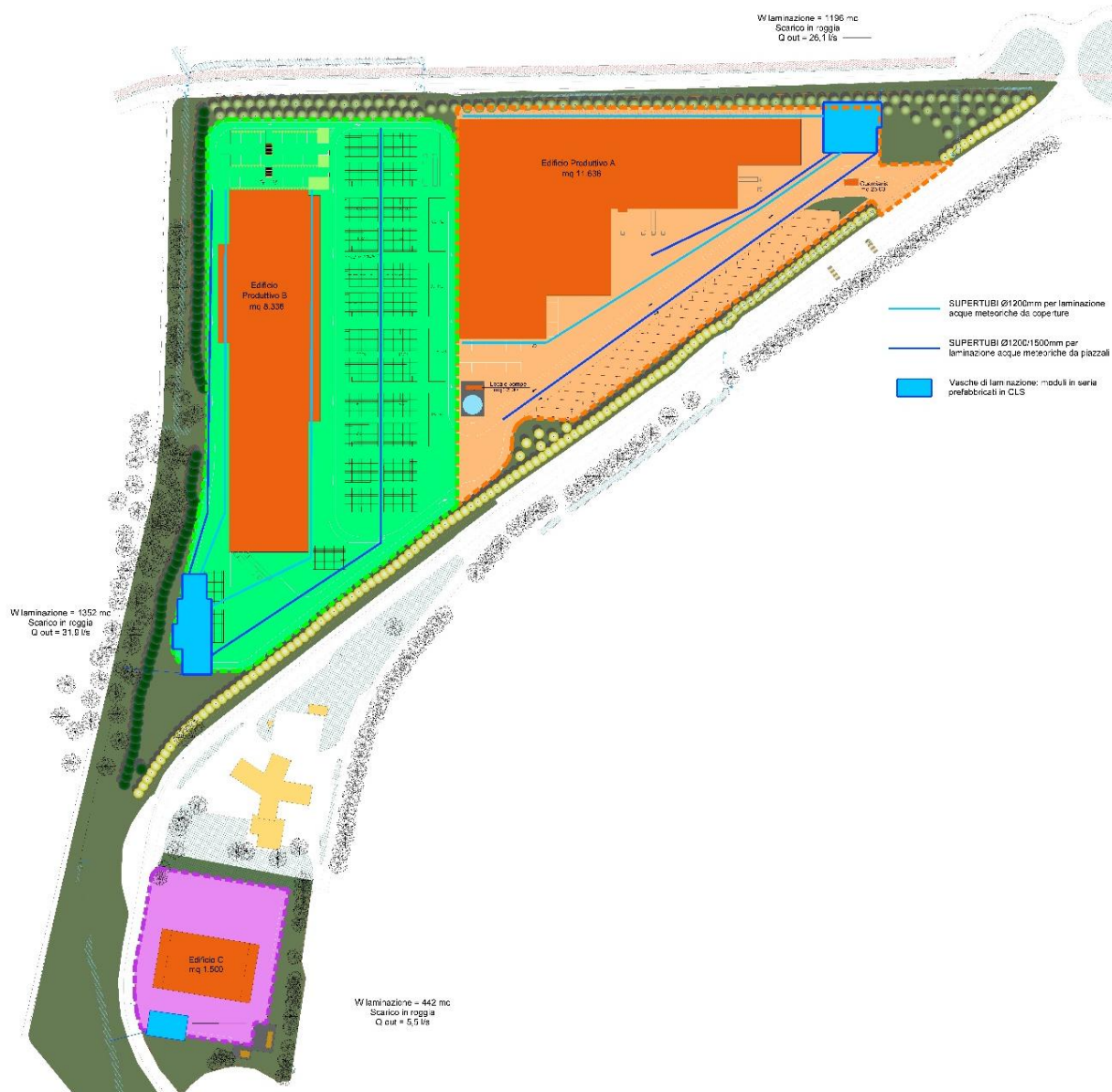
Figura 06.16 – Schema generale della rete di smaltimento delle acque meteoriche
